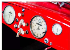
På denna BMW-racerbil sitter självklart varvräknaren precis framför föraren, hastighetsmätaren är placerad lite mer skydd till höger.
